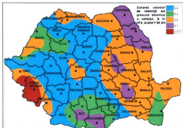
Fig. 14 - Evaluarea actiunii vântului asupra constructiilor
